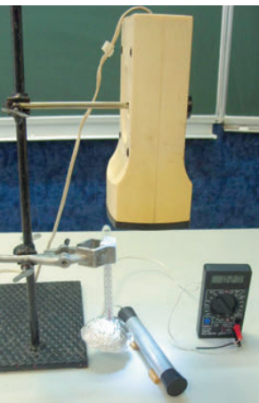
Рис. 3. Модельная установка для определения влияния солнечного излучения на температуру топлива в цистерне и кривые изменения температуры внутри модели цистерны с топливом и снаружи после 10-мин ИК-облучения
