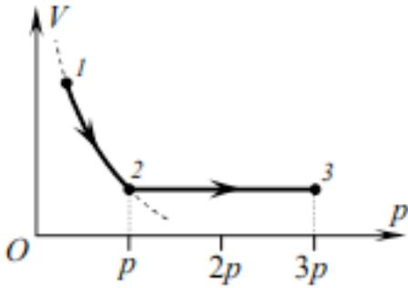
3. Один моль идеального одноатомного газа сначала изотермически расширился ( $T_1 = 300$  К). Затем газ охладили, понизив давление в 3 раза (см. рисунок). Какое количество теплоты отдал газ на участке 2-3?
