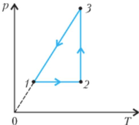
2. Цикл состоит из изохоры 1–2, изобары 2–3 и прямой 3–1 (см. рисунок). Температуры в точках 1, 2 и 3 связаны соотношениями  $T_2 = 1,5T_1$  и  $T_3 = 3T_1$ . Определите КПД цикла.
