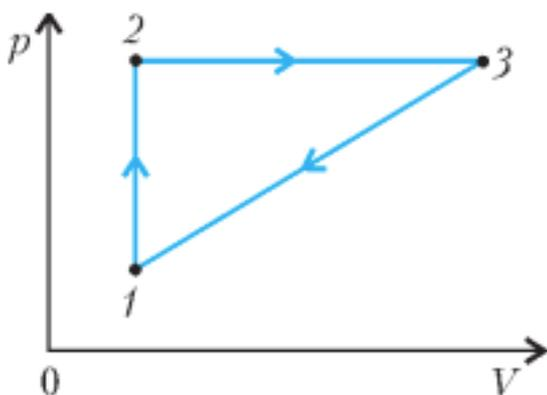
3. На  $pV$ -диаграмме, изображённой на рисунке, показано изменение состояния газа, используемого в качестве рабочего вещества теплового двигателя. Отношение максимальной абсолютной температуры газа к его минимальной температуре в данном цикле равно 4. Во сколько раз отличается КПД  $\eta$  этого цикла от максимально возможного?
